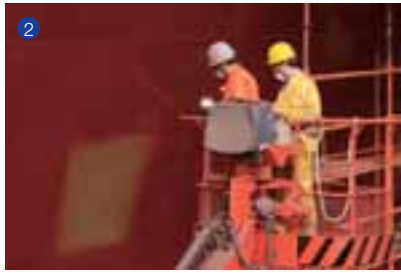
2 我們在船體的夏季載重線以下塗上低摩擦防污塗料，以減低船體水流阻力
